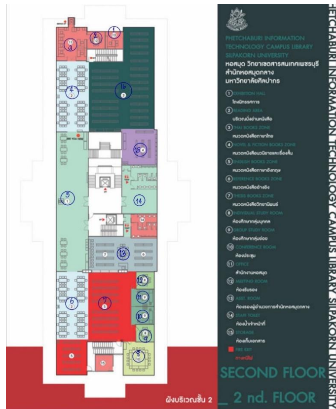
ผังแสดงจุดตรวจวัดระดับความเข้มของแสงสว่างพื้นที่ชั้น 2
