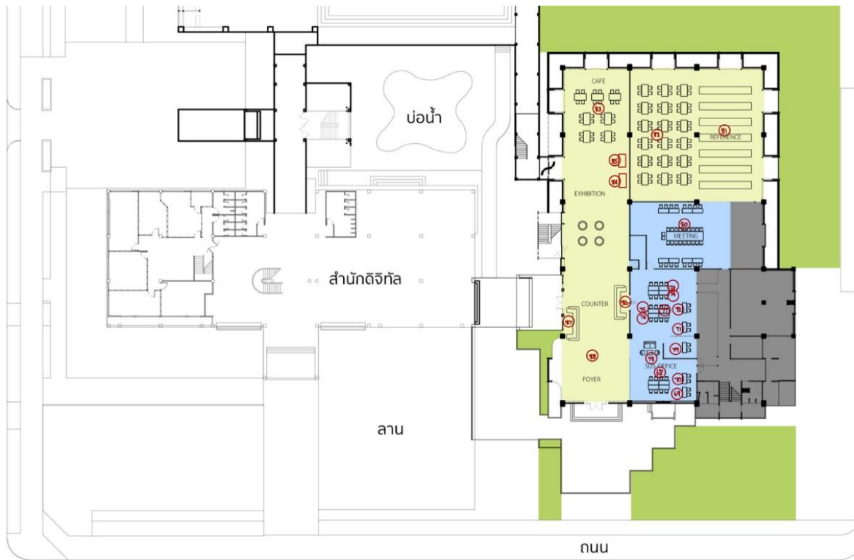
ผังแสดงจุดตรวจวัดระดับความเข้มของพื้นที่ชั้น 1 อาคารหอสมุดกลาง
